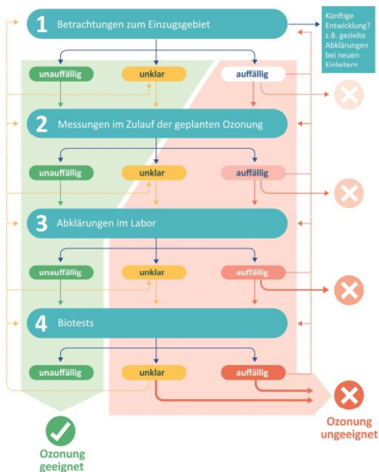
Abbildung 1: Schematische Darstellung der Abklärungen zur Eignung von Ozon für Abwasser. Die gestrichelten Linien deuten an, dass bei unklaren/auffälligen Resultaten gewisse Abklärungen wiederholt werden sollten. Die Mutagenität wird in 4te Module mit dem Ames Test untersucht. Quelle: VSA
