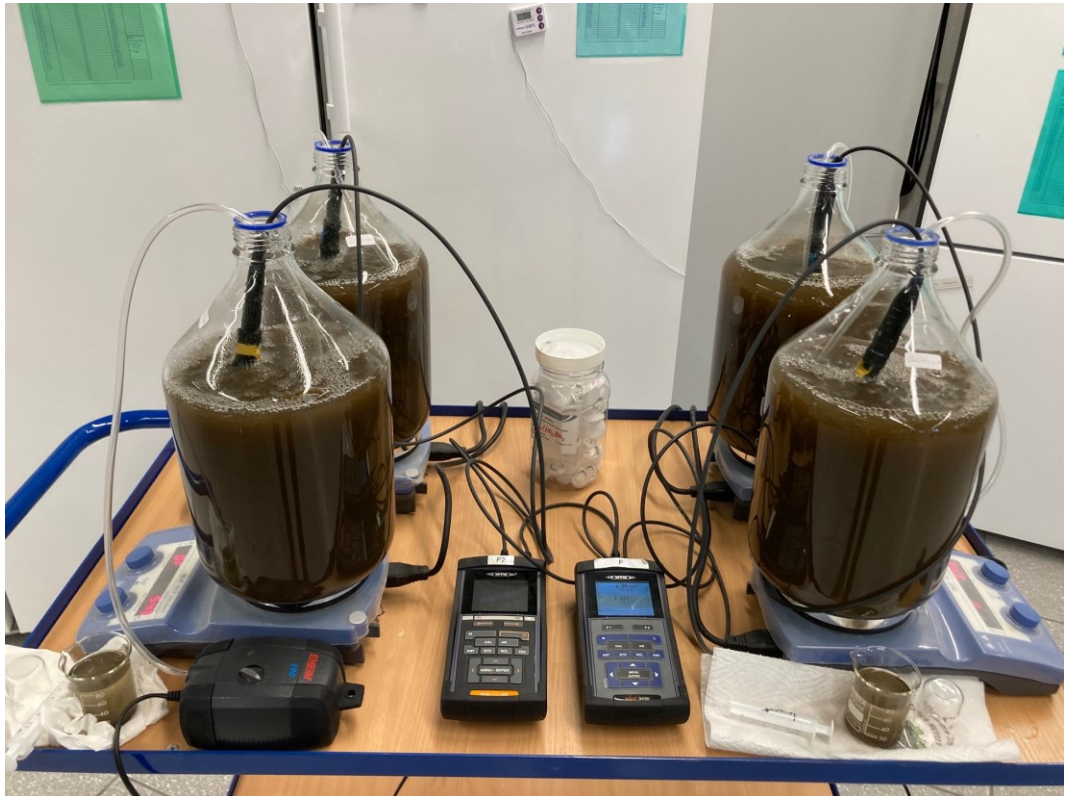
Abbildung 5: Versuchsaufbau der Labor-Nitrifikation.
